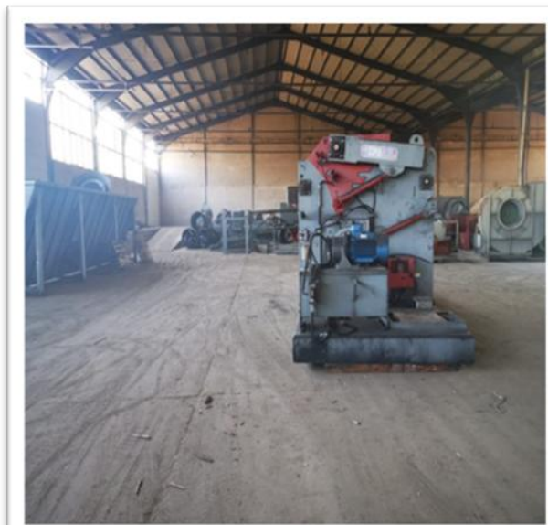
Слика бр.8 Линија за рециклажу пнеуматика - делови
